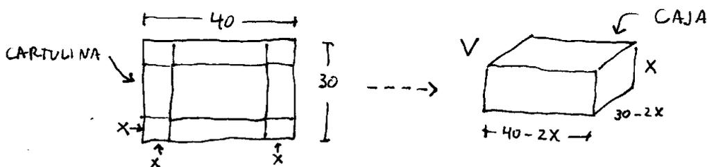
El volumen de la caja será:  $\text{Vol} = \text{ancho} \times \text{alto} \times \text{largo}$ . Es decir:
